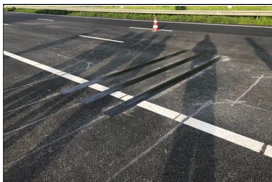
Figuur 3 Meetsysteem in de weg (links) en drukprofiel gemeten banden (rechts). In de 3D-grafiek zien we links de meting van een dubbelluchtband, rechts een enkele band. In de x-richting zijn de metingen van de drie sensoren te zien.
